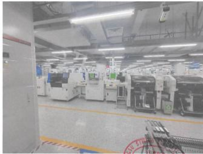
图1 印刷过程为全封闭自动化作业
